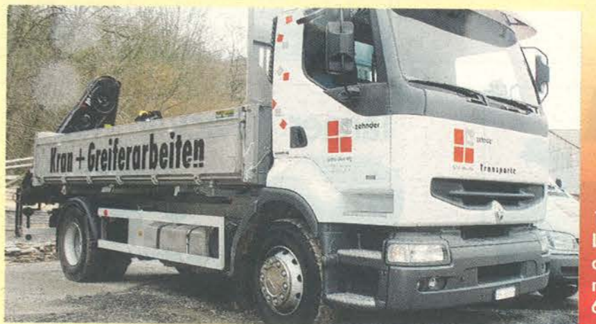
18-Tonnen-Lastwagen, ausgerüstet mit einem 6-Tonnen-Kran
